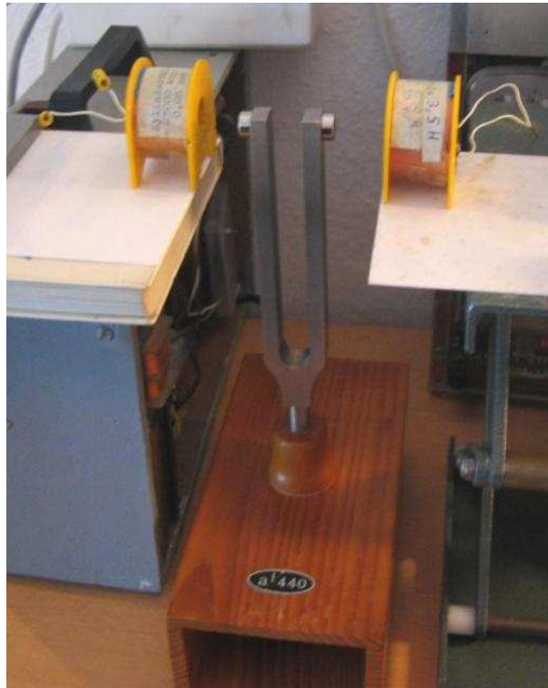
Abbildung 2: Stimmgabel mit angehefteten Permanentmagneten. Davor jeweils Aktor- und Aufnehmerspule, die über einen Hubtisch vor den Magneten positioniert werden konnten.
