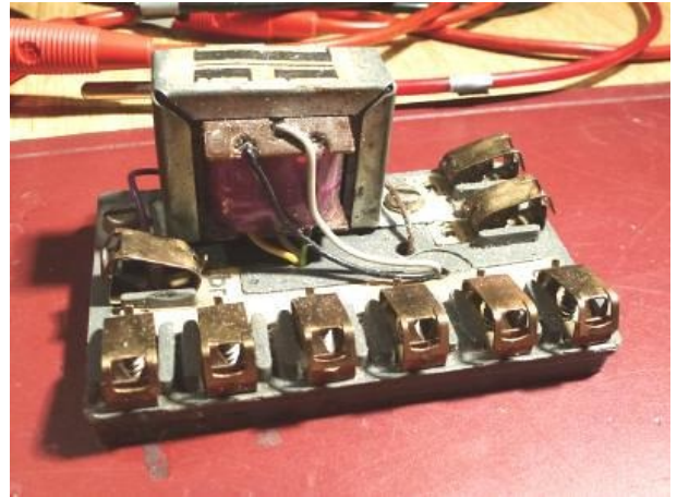
Abbildung 3: Ein Experimentiertrafo aus einem Elektronikbaukasten dient als Tonfrequenzübertrager
